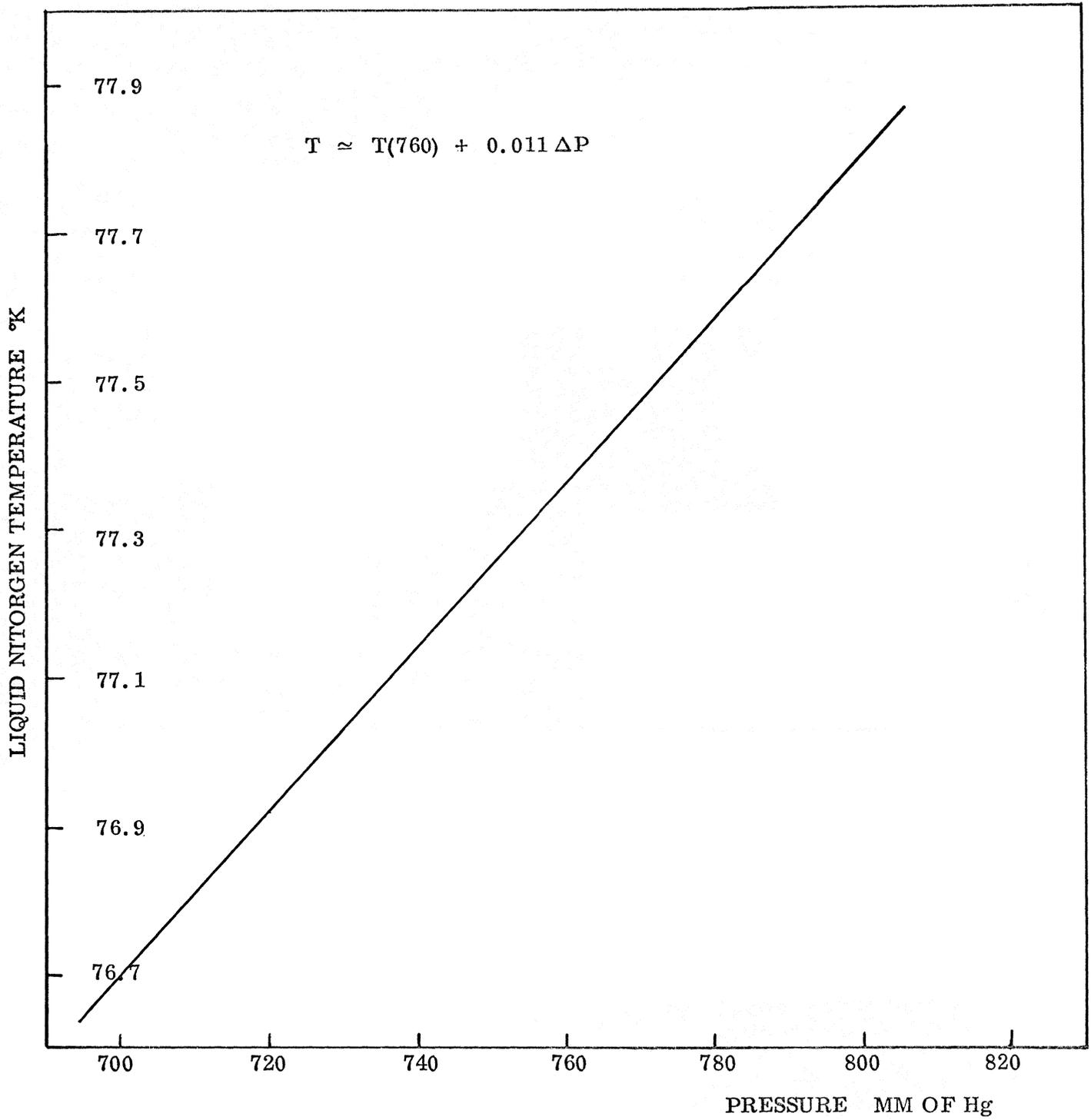
FIG. 7 -- LIQUID NITROGEN TEMPERATURE VERSUS VAPOR PRESSURE
