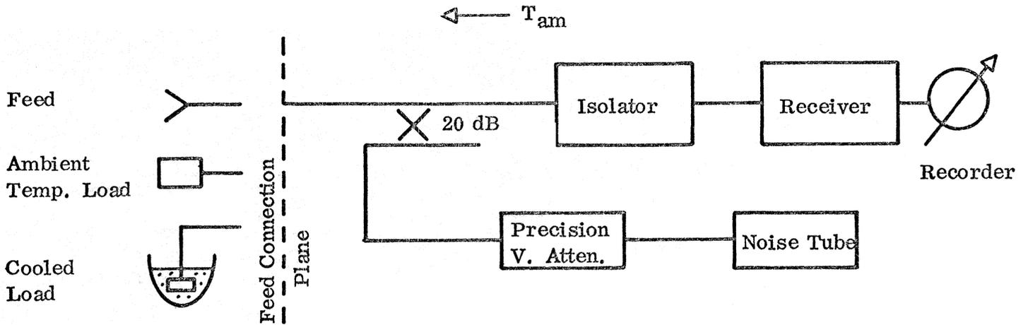
FIG. 1 -- BLOCK DIAGRAM OF BASIC RADIOMETER
