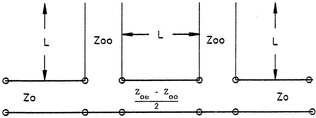
FIG 1 D.C. BLOCK MICROSTRIP CIRCUIT AND EQUIVALENT CIRCUIT.
