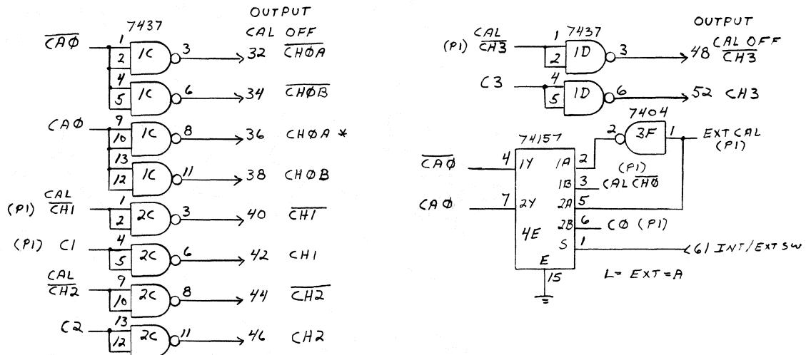
\* NORMAL OUTPUT IS  $CH\phi, A+B$ ,  $CH1$ ,  $CH2$ ,  $CH3$
