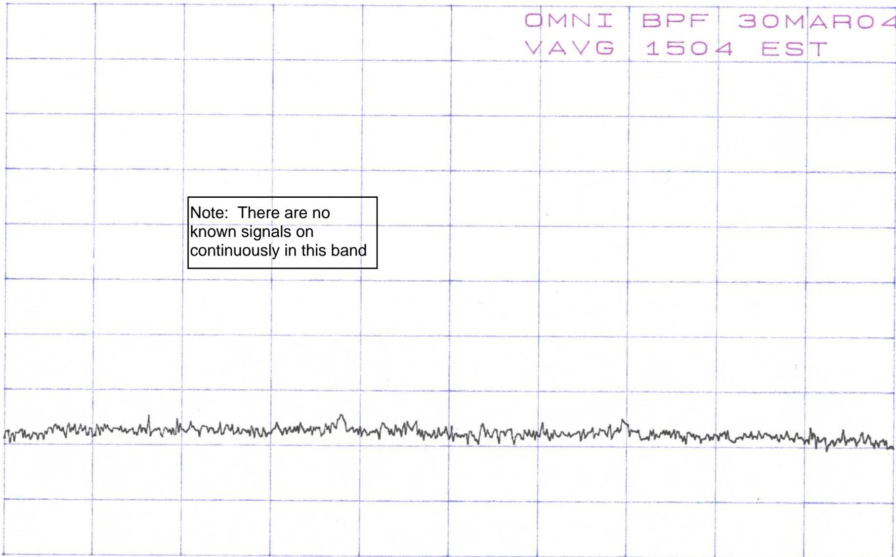
CENTER 134.000MHz SPAN 6.000MHz
